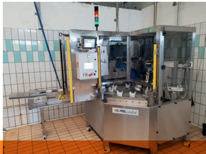
Macchina speciale confezionamento burrate Burrata custom packing machine
