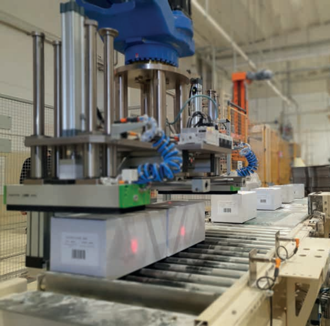
Palletizzazione scatole fondo-coperchio // Palletizing cell for bottom-cover carton boxes
