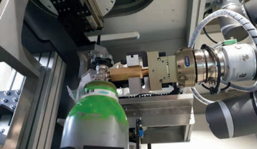
Avvitatura con controllo di coppia robotizzata Robotic torque-controlled screwing
