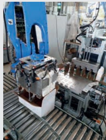
Inscatolamento robotizzato pacchi multipli Automated boxing of multiple parcels
