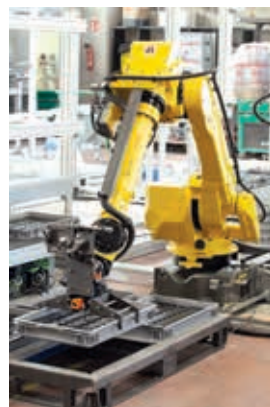
Cella robotizzata asservimento macchine utensili Robotized machine CNC loading cell
