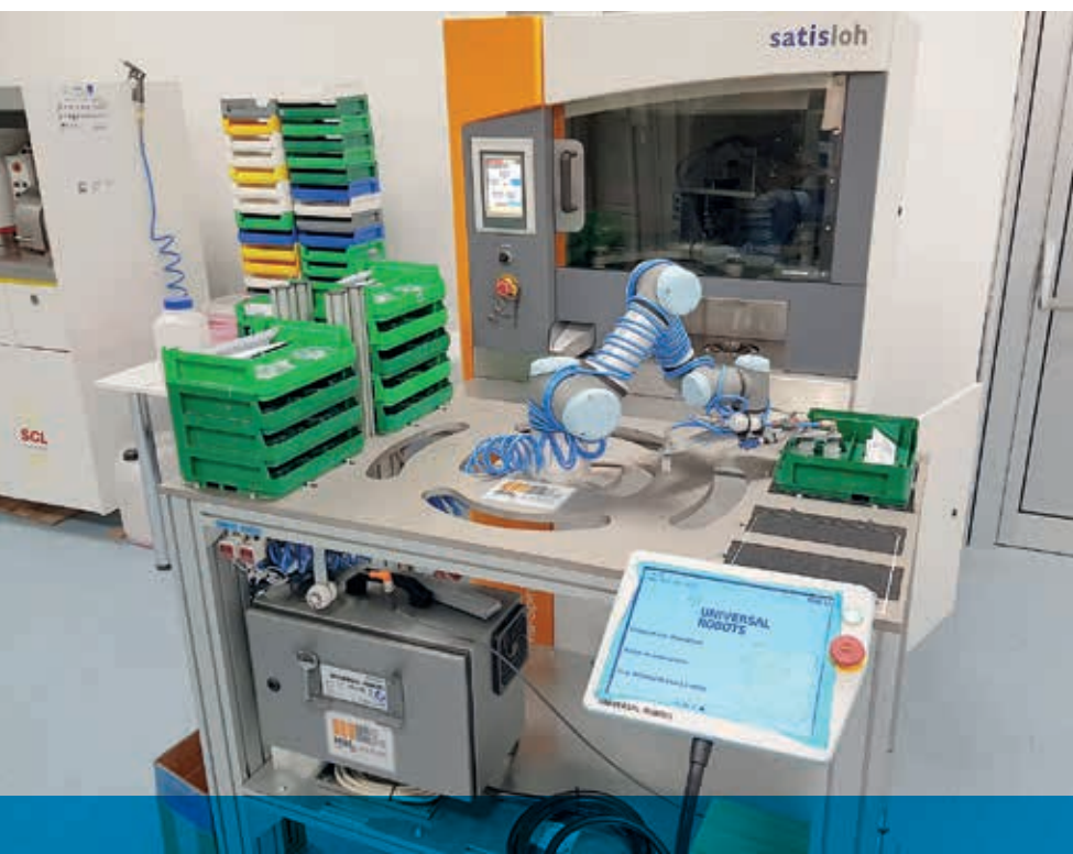
Asservimento macchine utensili con COBOT Loading machine tools with COBOT
