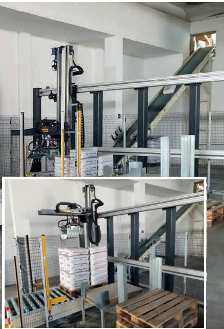
Pallettizzatore cartesiano a sbalzo per sacchi // Cartesian cantilever palletizer for bags
