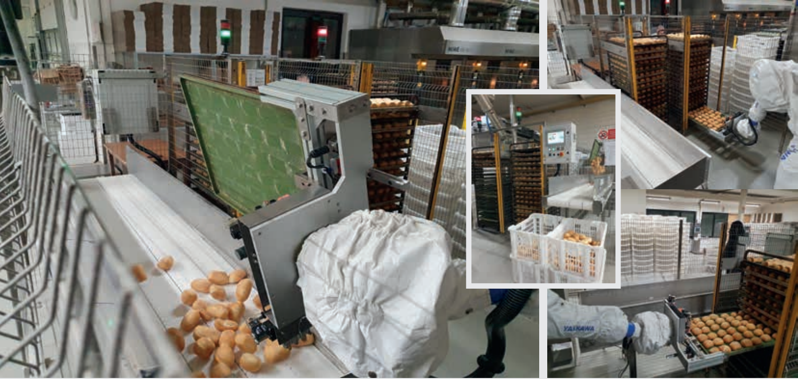
Scaricatore robotizzato industria della panificazione // Robotic unloader for bakery industry
