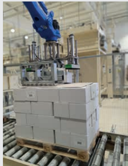
Palletizzazione scatole fondo-coperchio // Palletizing cell for bottom-cover carton boxes
