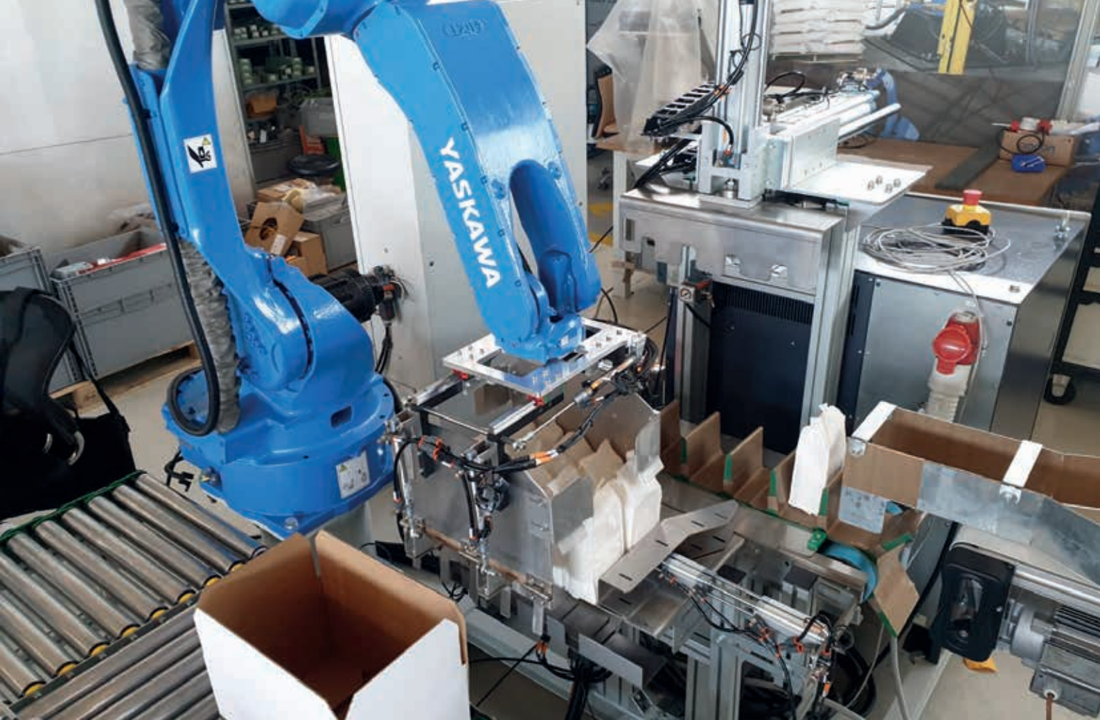
Inscatolamento robotizzato pacchi multipli Automated boxing of multiple parcels
