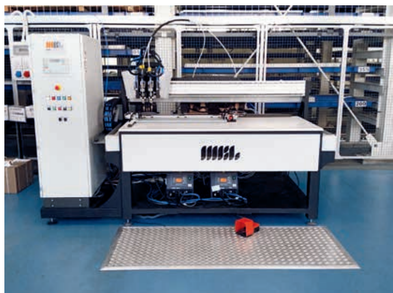
Macchina speciale saldatura perni Custom pin welding machine
